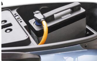
Bateria conectada ao ciclo elétrico
