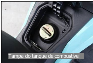
Tampa protetora do tanque
