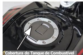
Cobertura do Tanque de Combustível
