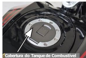
Cobertura do Tanque de Combustível
