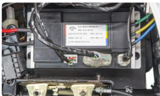
Módulo controlador (ECU) com tampa protetora SE 1
