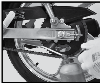
LUBRIFICAÇÃO DA CORRENTE DE TRANSMISSÃO.
